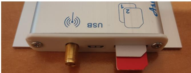
SIM-картки вставляються до упору. Можливі три варіанти виготовлення модему: а) після вставляння до упору краї SIM-карток визирають приблизно на 1..1,5 мм; б) краї SIM-карток знаходяться врівень з пластиковою кришкою; в) SIM-картки заховані за кришкою, щілини для їх установки немає, SIM-картки вставляються в слоти при знятті кришки. На фото нижче показаний варіант а).
