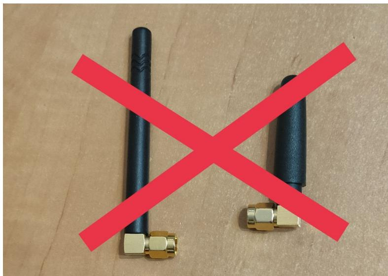
Справа у тому що при конфігурації (і тільки при конфігурації!) швидкисний USB-порт модему може давати наводки на таку антenu (штир без кабелю), що приведе до помилок при конфігурації. Для конфігурації можна використовувати антenu будь якого типу з **ПОДОВЖЮЧИМ КАБЕЛЕМ** (довжина неважлива), наприклад, як на фото нижче. Нагадуємо, що саме така антена (з подовжуючим кабелем 3м) їде у штатному комплекті модему.
