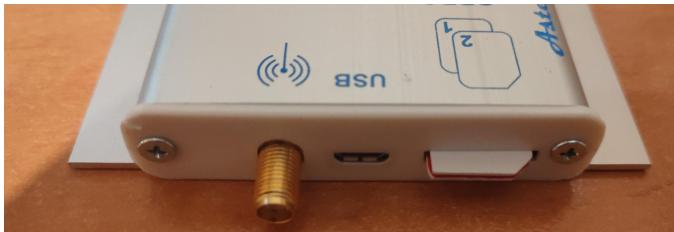
**Увага! За замовчуванням, модеми постачаються у однокартковому виконанні. В цьому випадку, використовують тільки слот SIM1, а в слот SIM2 картку вставити неможливо**
